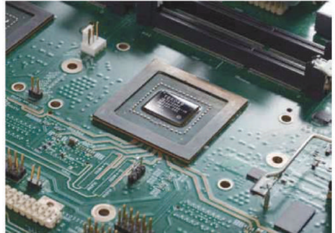
圖 3. TEK049 ASIC 專為最新一代示波器而設計
