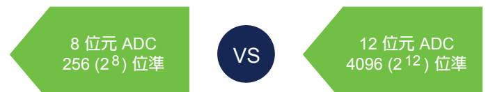
圖 2. 僅對 ADC 新增幾個位元就顯著改善了 ADC 可以解析的電壓位準數量。
