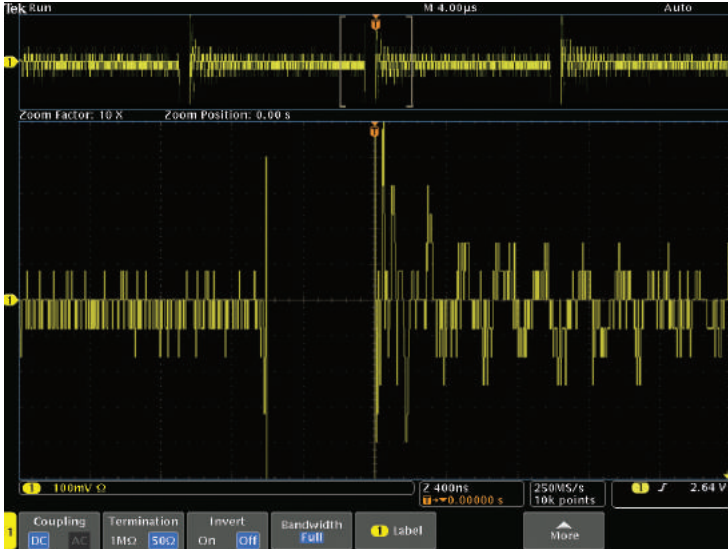
圖 5. 在 8 位元解析度的 MDO4000C 示波器上的振鈴
