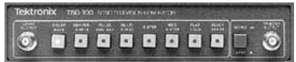
図3. TSG100型NTSCゼネレータ ビデオ機器やビデオ・システムのテストに使用する特殊なビデオ信号を発生します。NTSCはNational Television System Committeeの略称で、日本国内や米国で使用されているテレビジョン方式を勧告した委員会の名前です。
