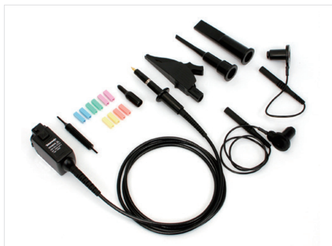
図5. テクトロニクスのTPP0850型電圧プローブ。シングルエンド、グランド基準のプローブであり、50 : 1の減衰比 (最大1000V rms ) と800MHzの周波数帯域を持つ
