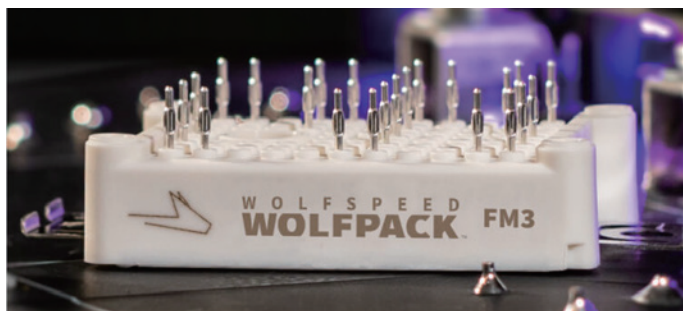
図1. Wolfspeed社製、WolfPACK FM3/パワー・モジュール。ピン・グリッド・デザインにより、スケーラビリティと使いやすさに優れている。写真提供：© Wolfspeed. 複製許可取得済み
