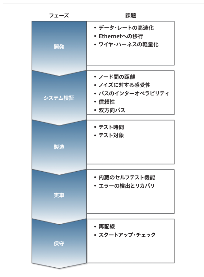
図2. ライフサイクル全段階での一貫性のあるテストにより、システム障害を容易に防ぐことができ、結果としてますます増える自律走行車の安全で信頼性の高い操作が可能になる
