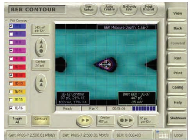
図16. ISIフィルタ（ロング・ケーブル）、正弦波ジッタ、ランダム・ジッタ、正弦波ノイズ（垂直方向の閉じをもたらす）を含んだストレス・アイのアイ・ダイアグラム（左）とBER等高線（右）の例。最も困難と思われるレシーバの代表例
