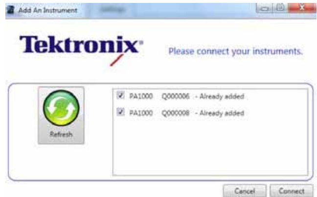
图 19. 通过 PWRVIEW 连接的两台 PA1000 实例。
