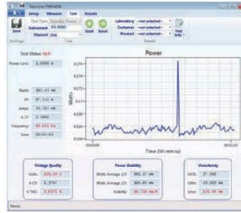
IEC62301コンプライアンス・テストのスクリーン
