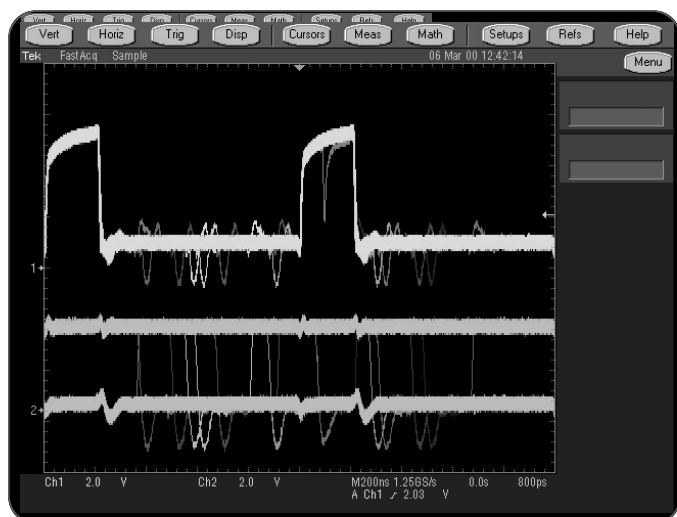
図52. DPOは、波形取込レートが非常に高速であり、また3次元表示が可能のため、信号の細かい振舞までも非常に詳しく観察できます。この優れた性能により汎用設計からトラブルシューティング・ツールに至るまで、非常に広範な分野でご使用いただけます。
