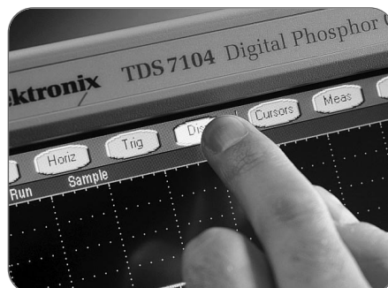
図61. タッチパネル・ディスプレイでは、キーボードのようにながたつきを気にすることなく、画面上のボタンに簡単にアクセスできます。
