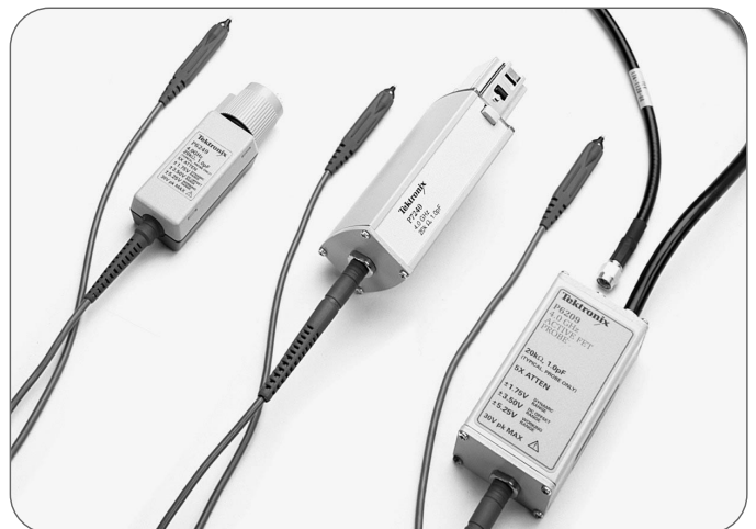
図44. TekConnectインターフェースを使用すると、10GHzまで信号の完全性を保持でき、今後の帯域幅に対する要求に応えられます。
