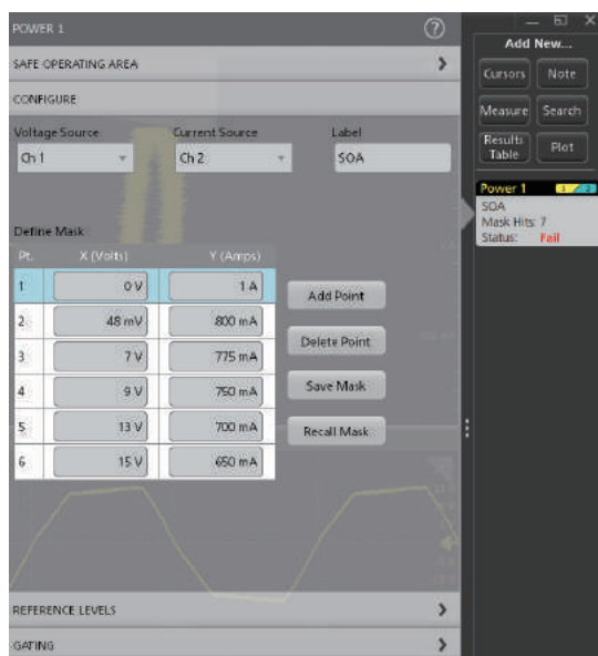
圖 13. SOA 遮罩編輯器視窗。遮罩可由取自切換裝置資料表的一組 (電壓、電流) 座標定義，或可由使用者自行定義。
