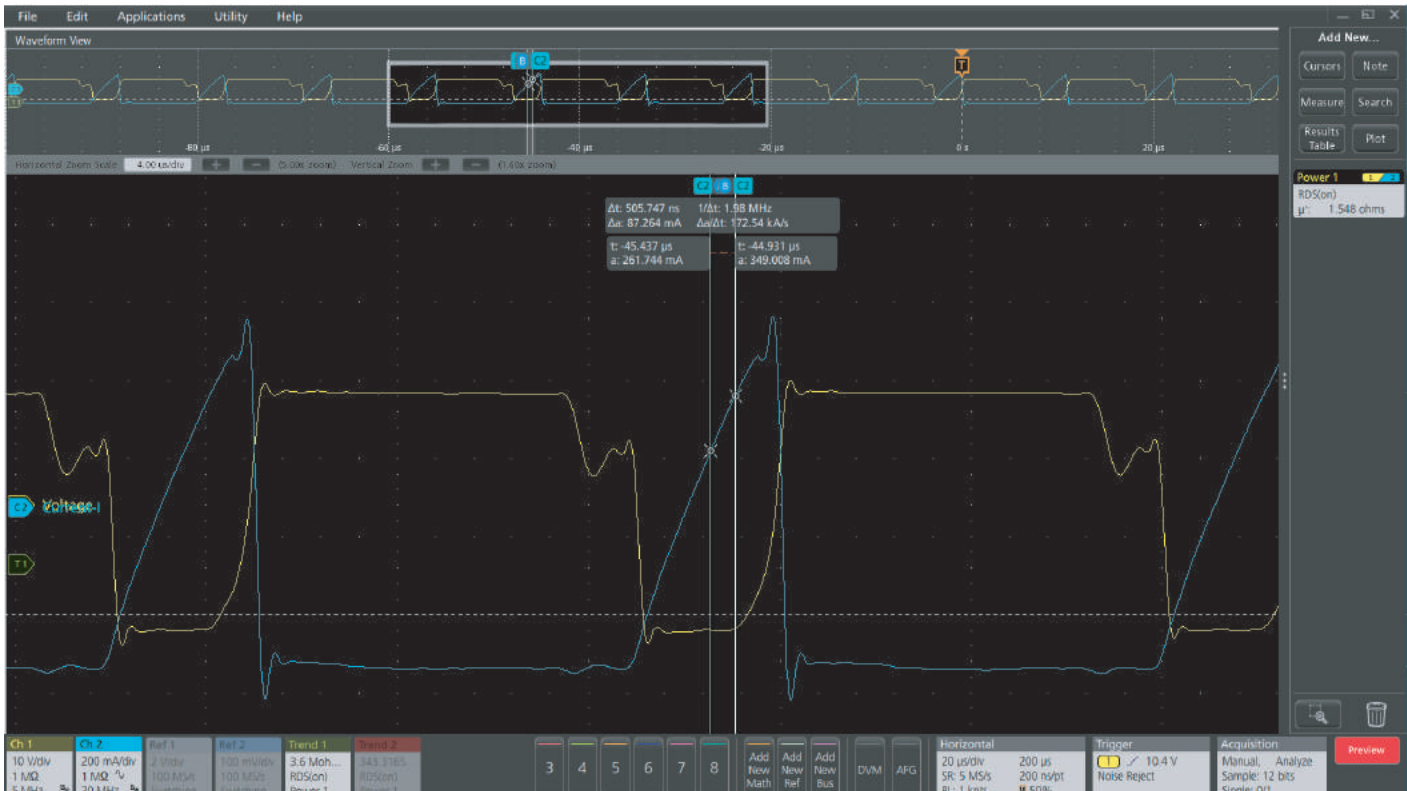
圖 10. RDS(on) 量測。Ch1 (黃色) 波形是 FET V_{DS} 電壓，Ch2 (青色) 波形則是 FET 電流。波形會在相位上呈現反相的狀態，以正確指示傳導區域中的電流過高。結果標記 (右上) 預設會顯示平均 RDS(on) 值，但也可以配置為顯示最小值。在本例中，游標閘控功能可用於尋找最小的 RDS(on) 值，通常接近 1 歐姆（圖中為 1.58 歐姆）。
