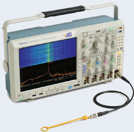
MDO4000シリーズはスペクトラム・アナライザ、オシロスコープ、ロジック・アナライザの機能を1台に統合しており、3種類の機能による測定を、時間相関をとって測定することが可能
