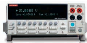
ハイコストパフォーマンスの低電圧ソースメータ2401型
