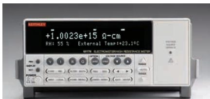
1kV電源内蔵6517B型
