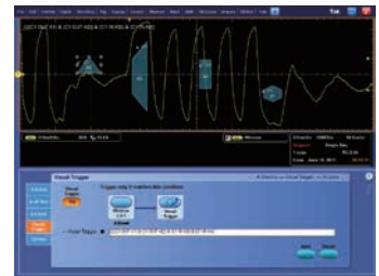
DDR信号へのトリガ例
