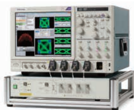
OM4000シリーズ・コヒーレント光信号アナライザ (CLSA) とテクトロニクスDPO70000Dシリーズ・オシロスコープ
