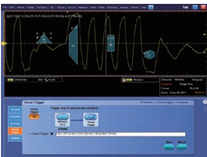
DDR信号へのトリガ例
