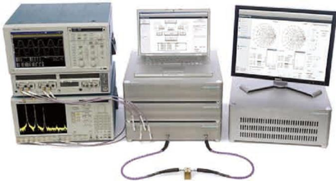
図5. テクトロニクス製の計測器の機能、性能を活用したMesuro社のソリューション。波形測定と高調波アクティブ・ロードプル機能の同時利用が可能
