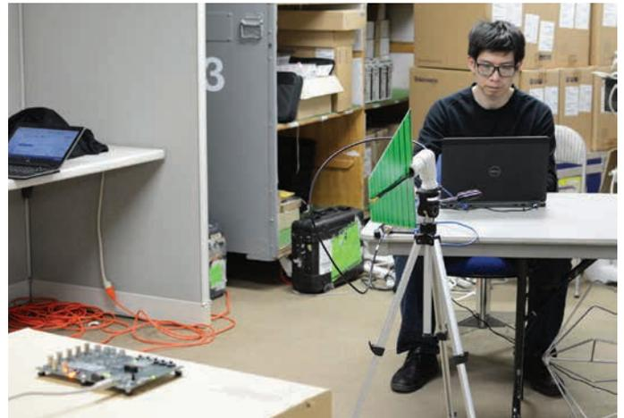
図7. ビルの地下に設置したプリコンプライアンス・テストのセットアップ例
