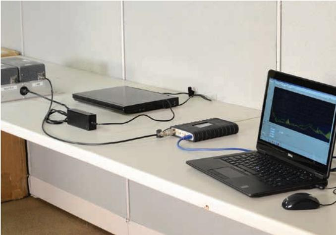
図13. 伝導エミッション・プリコンプライアンス・テストの基本的なセットアップ例
