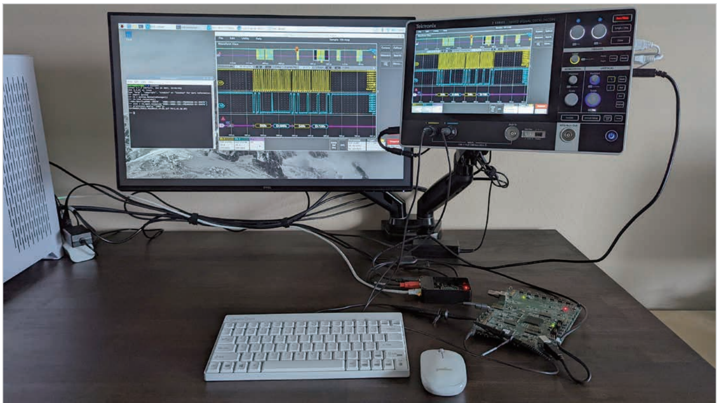
図1. テクトロニクスの2シリーズMSOとRaspberry Piのセットアップ例
