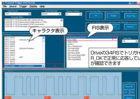
図2-①-5 Driveのプロトコル・デコード画面
