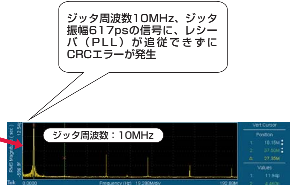
図2-3-6 スペクトラム表示によるジッタ周波数の表示
