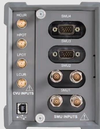
4200A-CVIV型の外部接続を示しています。C-V測定は、配線切替せずに任意の出力チャンネルに移動できます。4200A-PA型プリアンプまたは4200A-CVIV-SPT型SMU/Vススルーによる標準の電流分解能を使用することで、各チャンネルは低電流測定用にユーザ設定できます。4200A-CVIV型は、4200A-SCS型メインフレームからUSBケーブルで電源供給されます。
