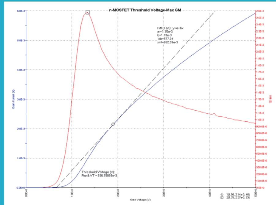
$V_{GS}$ - $I_D$  テストでは、ソースに対してゲートを一定の電圧に保ち、ゲート-ソース電圧を掃引してドレイン電流を測定する
