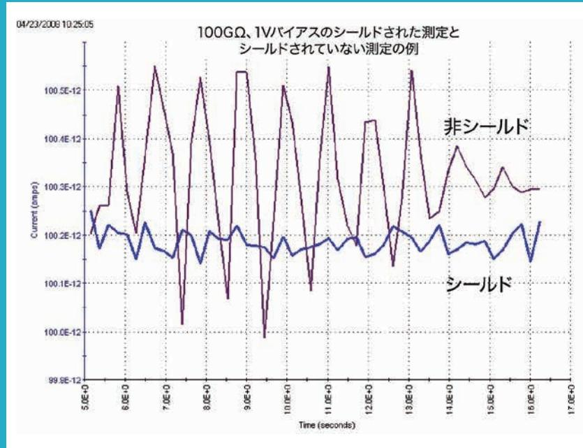
帯電された物体が帯電されていない物体に近づくと、静電干渉が発生します。小さな抵抗では帯電は急速になくなるため、通常は干渉の影響は気づかないレベルです。しかし、高抵抗の材料では帯電は急速にはなくならず、不安定な測定になります。一般に、 $1\text{nA}$ 以下の電流測定または $1\text{G}\Omega$ 以上の抵抗測定で静電干渉が問題になります。静電界の影響を抑えるには、測定する回路をシールドで覆います。 $100\text{G}\Omega$ 抵抗をシールド測定と非シールド測定で比較した例を示します。非シールドの測定は、シールドされた測定に比べてノイズが大きくなっています。
