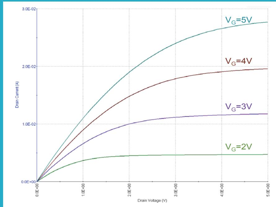
$V_{DS}$ - $I_D$  テストにより、デバイスの特性と設計で必要な特性評価を理解する。
