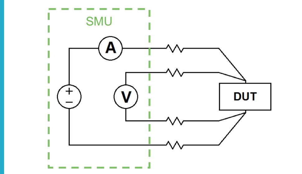
2線式でなく、4線式接続でDC測定することで、リード線の抵抗による誤差を最小限に抑えられる
