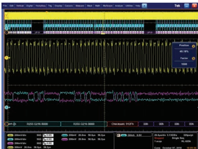
図54. MSO70000Cシリーズで表示されたPacked Pixel Streamのアナログ・チャンネル・デコード表示 - チェックサム・エラーが確認できる
