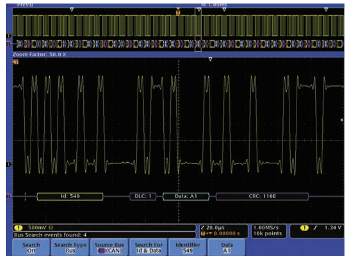
図45. CANバスの取込みから、指定した識別子とデータで検索した結果の例
