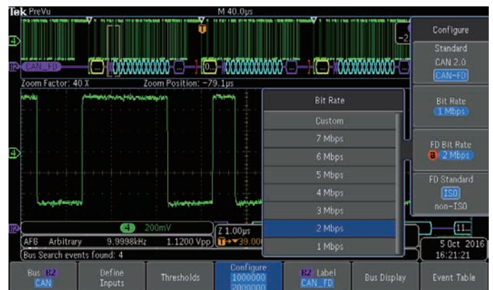
図33. CAN 2.0またはCAN FD規格、ISOと非ISOバージョン、FDビット・レートなどの設定メニュー
