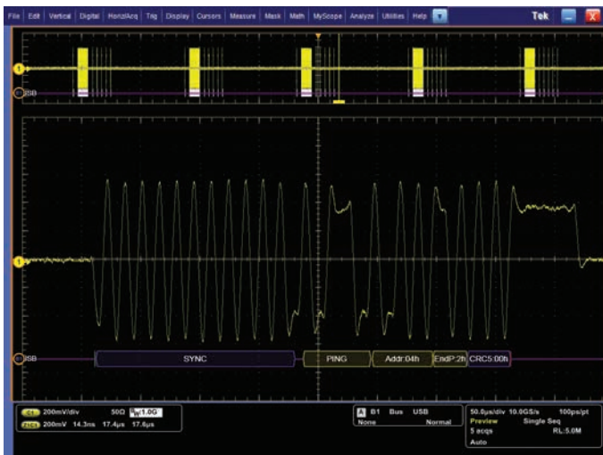
図23. MSO5204型Opt. SR-USBで取込み、デコード表示したハイスピードUSB 2.0の波形
