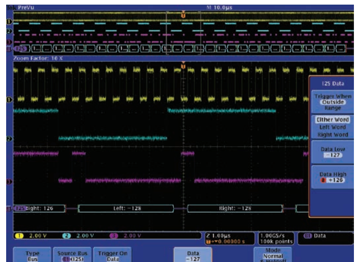
図49. I2Sバスにおいて設定範囲外の値にトリガした例
