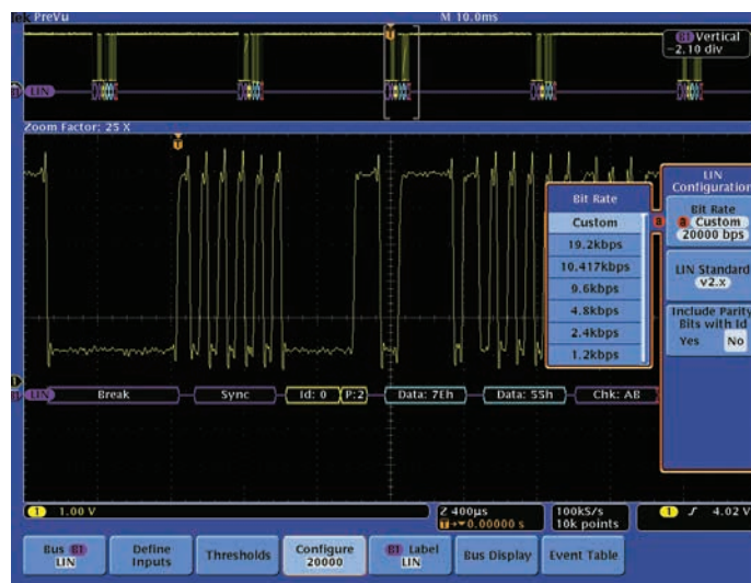
図35. LINバス・サポートの設定メニューとデコードされたフレーム
