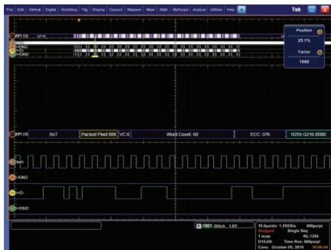
図53. MSO70000Cシリーズで表示された、Packed Pixel Stream、24ビットRGB 8-8-8フォーマット・ロング・パケットのデジタル・チャンネル・デコード表示
