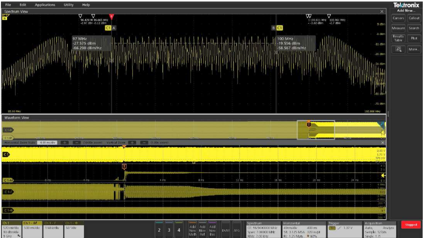
圖 13. 為了聚焦於時脈開啓，我們可使用「射頻與時間觸發」設定來指定閾值和邊緣來觸發射頻振幅波形（註：此量測是使用比圖 10-12 更新的韌體進行）。
