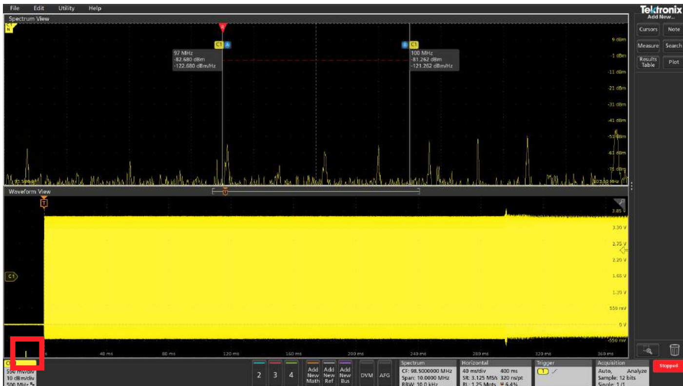
圖 6. 頻譜時間 (以紅色方框強調顯示) 放置在擷取內容的前段，即觸發事件之前。一如預期，由於時脈尚未開啓，因此頻域中沒有任何強訊號。
