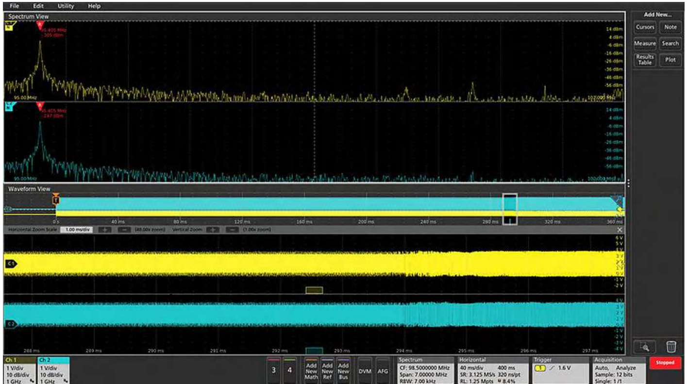
圖 15. 當除錯任務需要時，可以同時分析多個通道。此處兩個通道顯示一個時脈訊號從電路中兩個不同的點開始。
