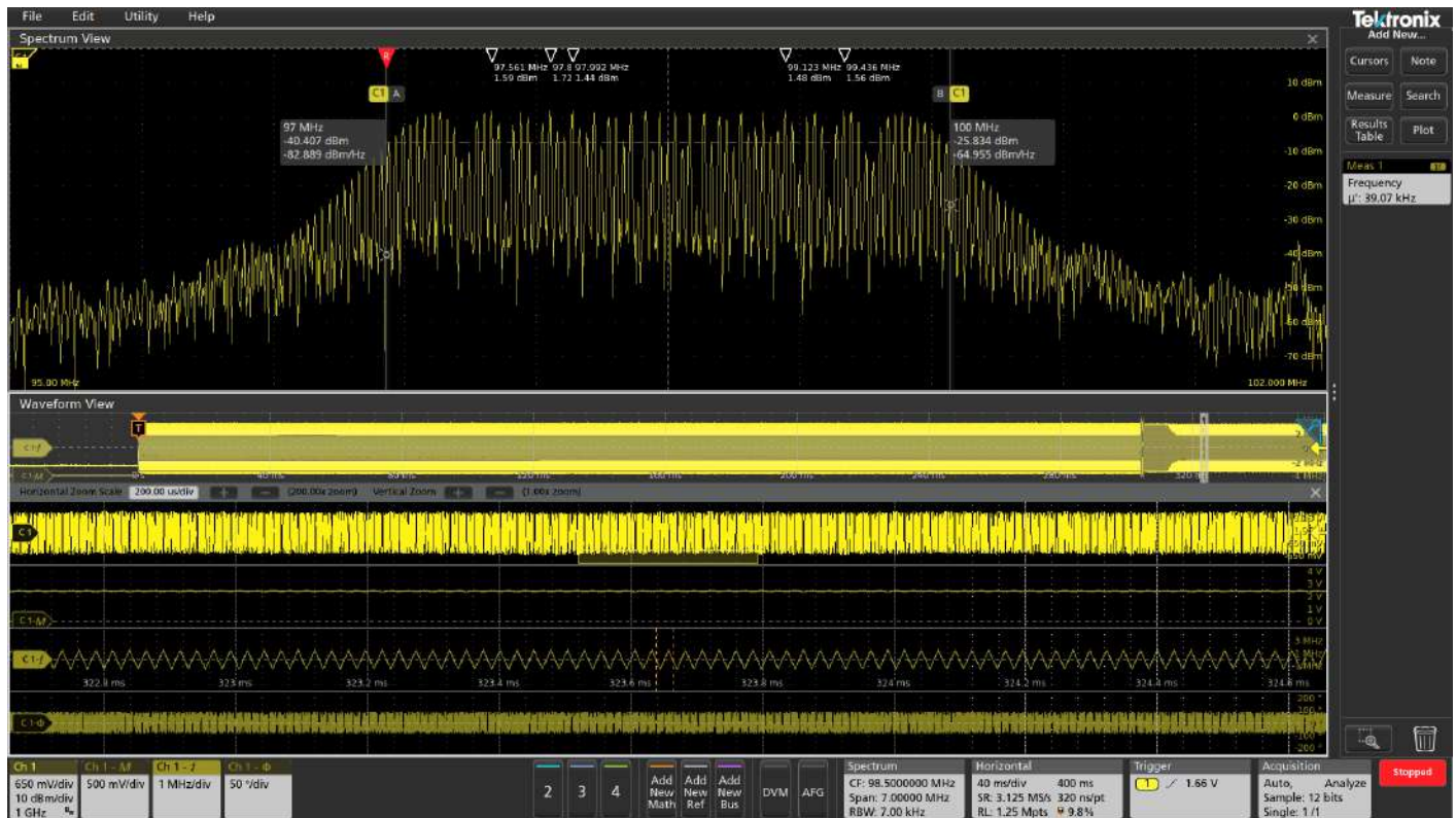
圖 12. 我們現在進一步放大，可以輕鬆查看正在使用的三角頻率調變，並可透過結果欄中的自動量測結果來確認我們獲得了 39.07 kHz 的正確調變率。
