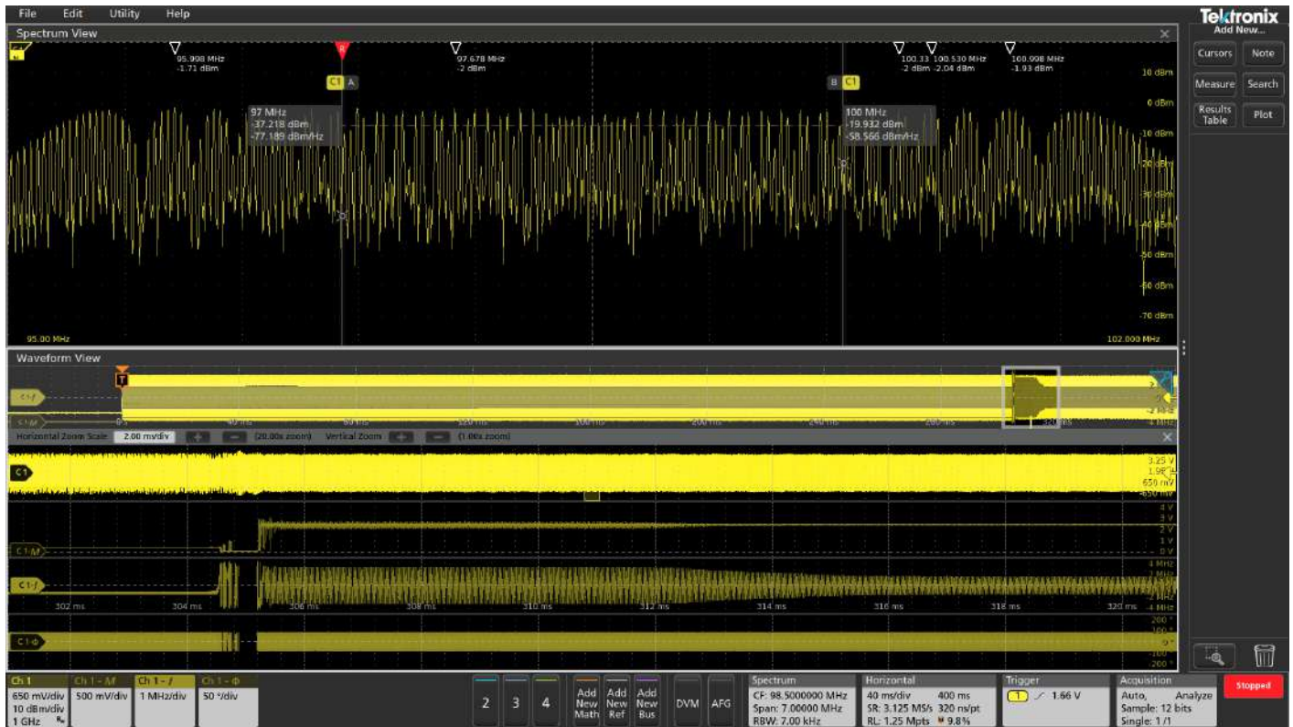
圖 11. 我們現在放大所關注的時間段 (觸發事件後大約 300-320 ms)。請注意，我們可以清楚地看到振幅波動和頻率變化超出了應有的範圍。
