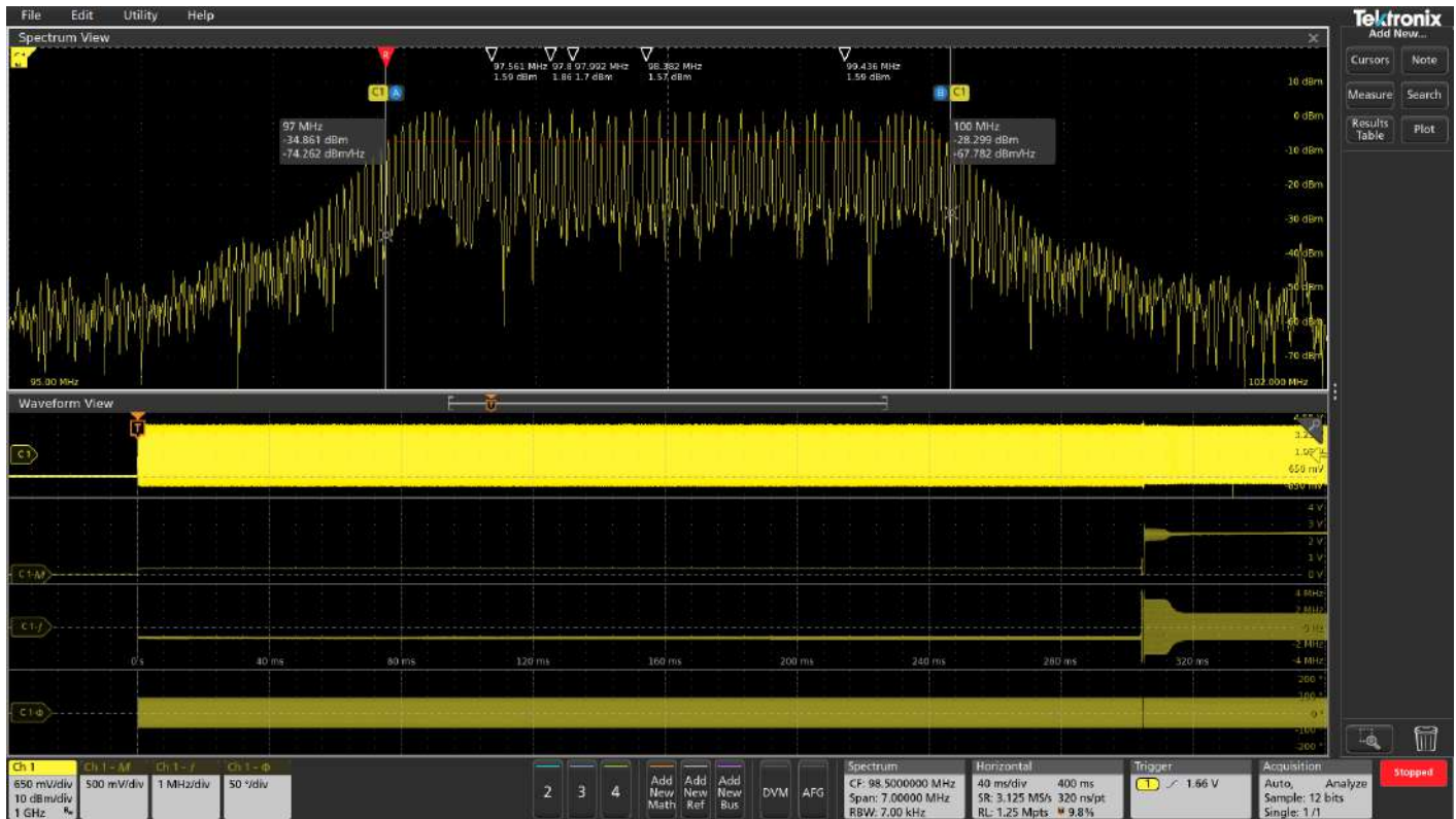
圖 10. 透過查看「振幅與時間」和「頻率與時間」波形，即可明顯看出展頻式時脈的情況。「振幅與時間」軌跡顯示訊號在位準極低的觸發點開啓，而「頻率與時間」軌跡顯示訊號在前 300ms 內停留在單一頻率上。此時，我們看到訊號的振幅顯著增加，且頻率開始變化。
