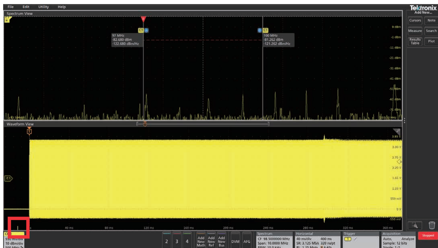
図6. スペクトラム・タイム (赤の枠で囲まれている) は取込みの前半、トリガ・イベントの前に設置されている。クロックはまだオンになっていないため、予想通り周波数ドメインでは強い信号は確認できない。
