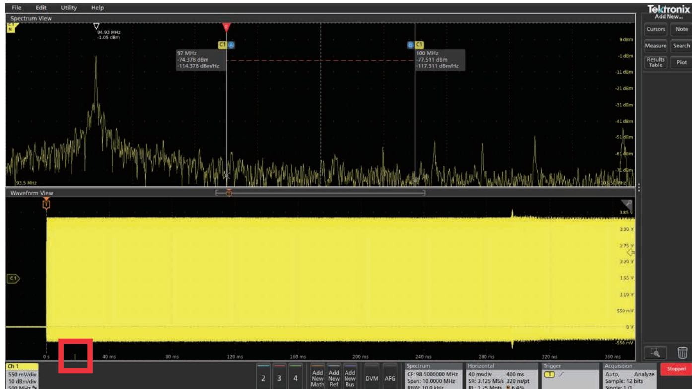
図7. スペクトラム・タイムはクロックがオンになった約20ms後に設置されている。クロック周波数は94MHzで、まだスペクトラム拡散はされていない。
