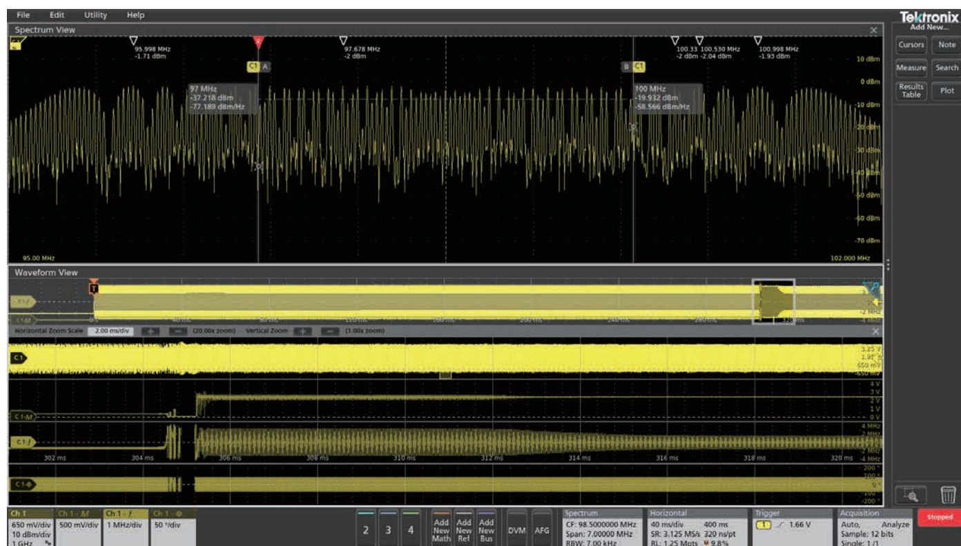
図11. 特定の期間でズーム表示している(トリガ・ポイント後の約300~320ms)。振幅が変動し、本来よりも広い範囲で周波数が変化してる様子がわかる。
