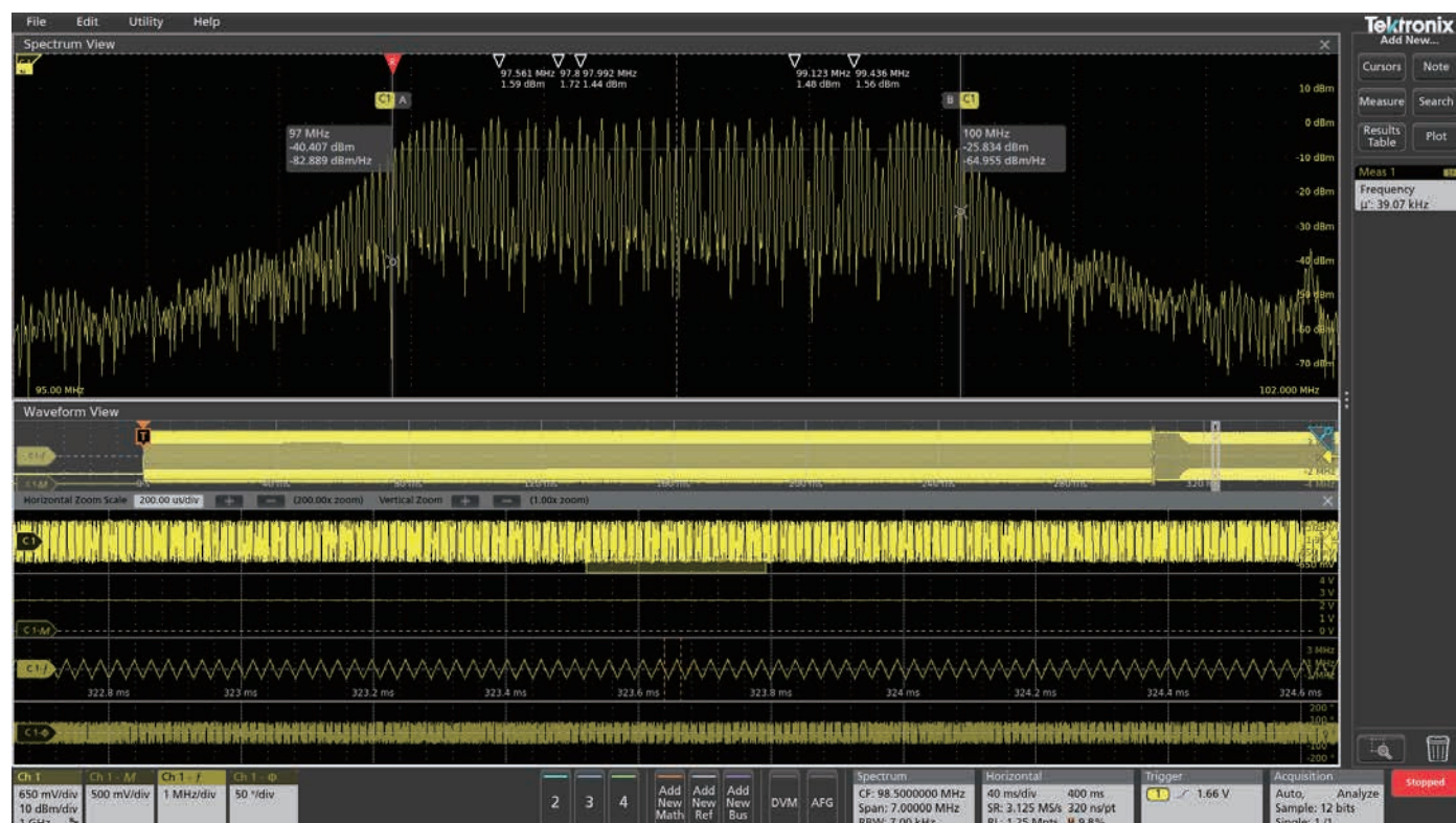
図12. さらにズーム表示することで三角周波数変調の様子がわかり、結果バーの自動測定により39.07kHzの正しい変調レートになっていることがわかる。
