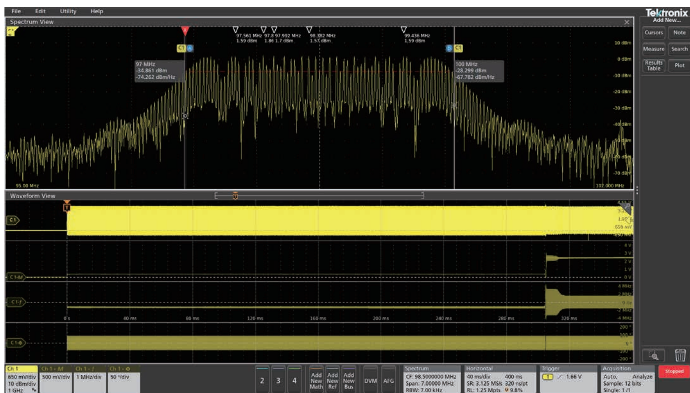
図10. 振幅対時間波形、周波数対時間波形により、この拡散スペクトラム・クロックの変化の様子が容易に観測できる。振幅対時間波形では、非常の小さなレベルのトリガ・ポイントで信号がオンになっている様子が、周波数対時間波形では最初の約300ms、一定の周波数にとどまっている様子がわかる。このポイントにおいて、信号の振幅が大きくなり、周波数が変化しだしていることがわかる。
