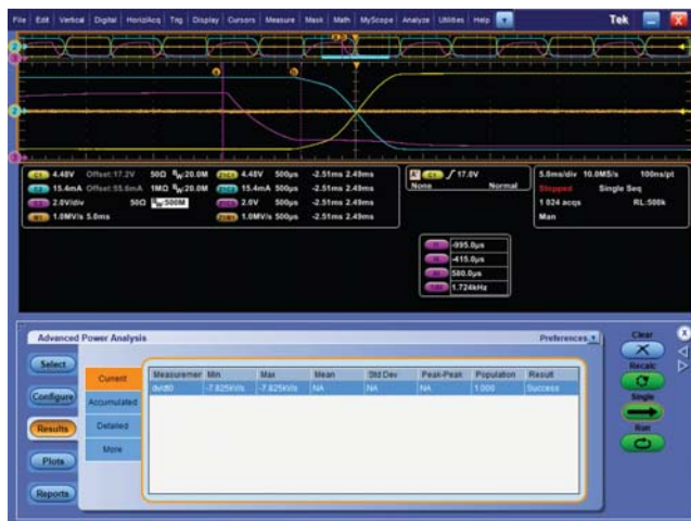
圖 7. 在 MOSFET 閘上的自動旋轉率量測。
