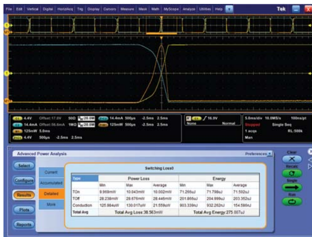
圖 8. DPOWPR 自動切換損耗量測，呈現顯著的改善。
