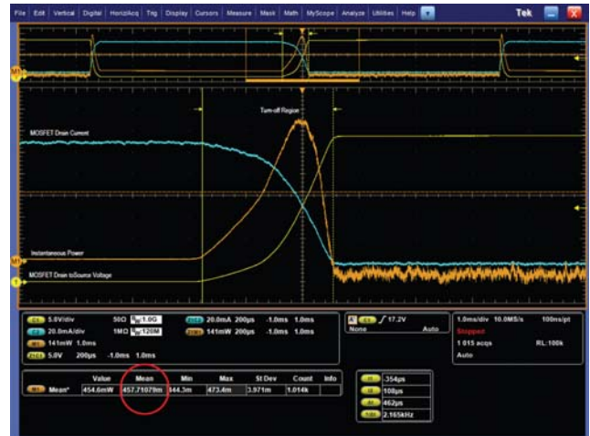
圖 4. 在 MOSFET 切換模式中關閉功率損耗的閘控自動量測。
