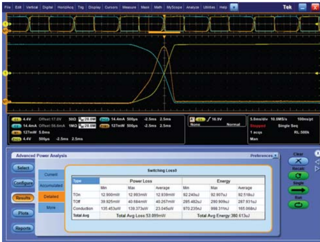
圖 5. DPOPWR 自動切換損耗量測。
