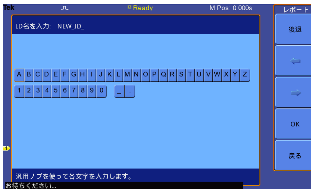
図 10: HTML レポート用のレポート ID をオシロスコープ上で入力する
