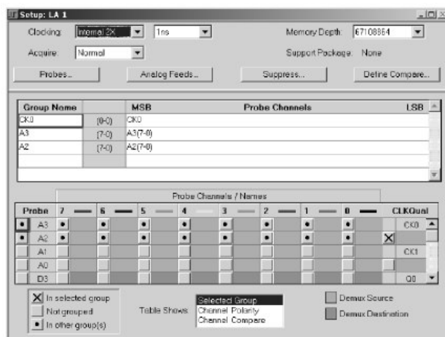
图 3-15 内部 2X 时钟方式的源和目的点探头通道
