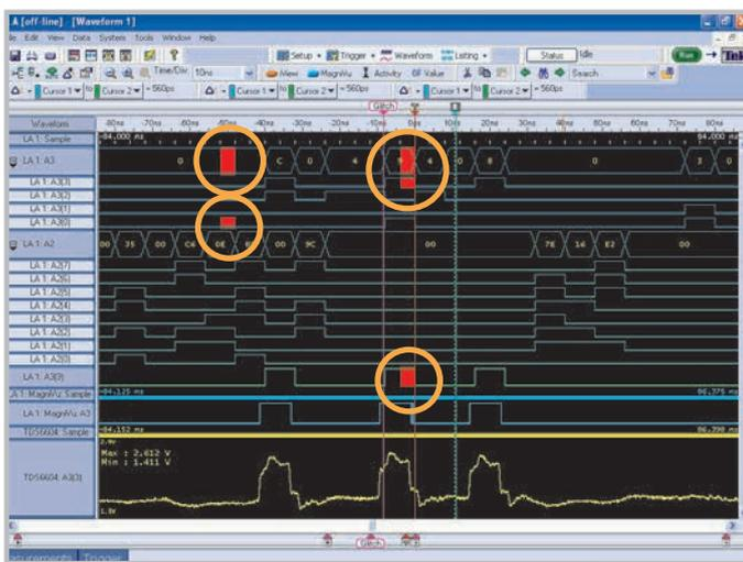
全チャンネル、グリッチ・トリガや、セットアップ&ホールド時間違反トリガを実現。トリガと同時に赤く識別表示もできます。違反でトリガをかけ、各信号の詳細なタイミングを40ps分解能のMagniVuで確認できます。
