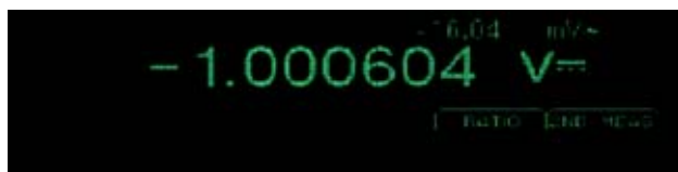
图 4. 使用 DMM4000 数字表的双参数测量功能测试纹波
