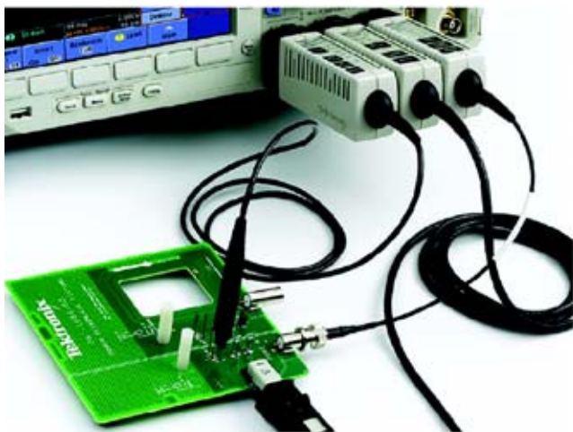
图 7. 泰克偏移校正脉冲发生器和偏移校正夹具。
