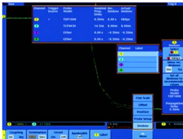
图 8. 手动消除电压探头和电流探头之间的定时偏移。
