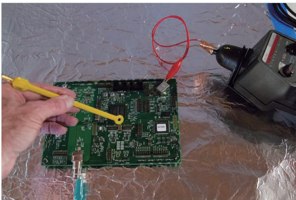
図5. ESDシミュレータを、500V程度の電圧に調整し、接触放電チップを使って被測定デモ・ボードに接続する。近接界プローブで基板周囲をスキャンし、最も大きな振幅の電圧ピークを観測する
