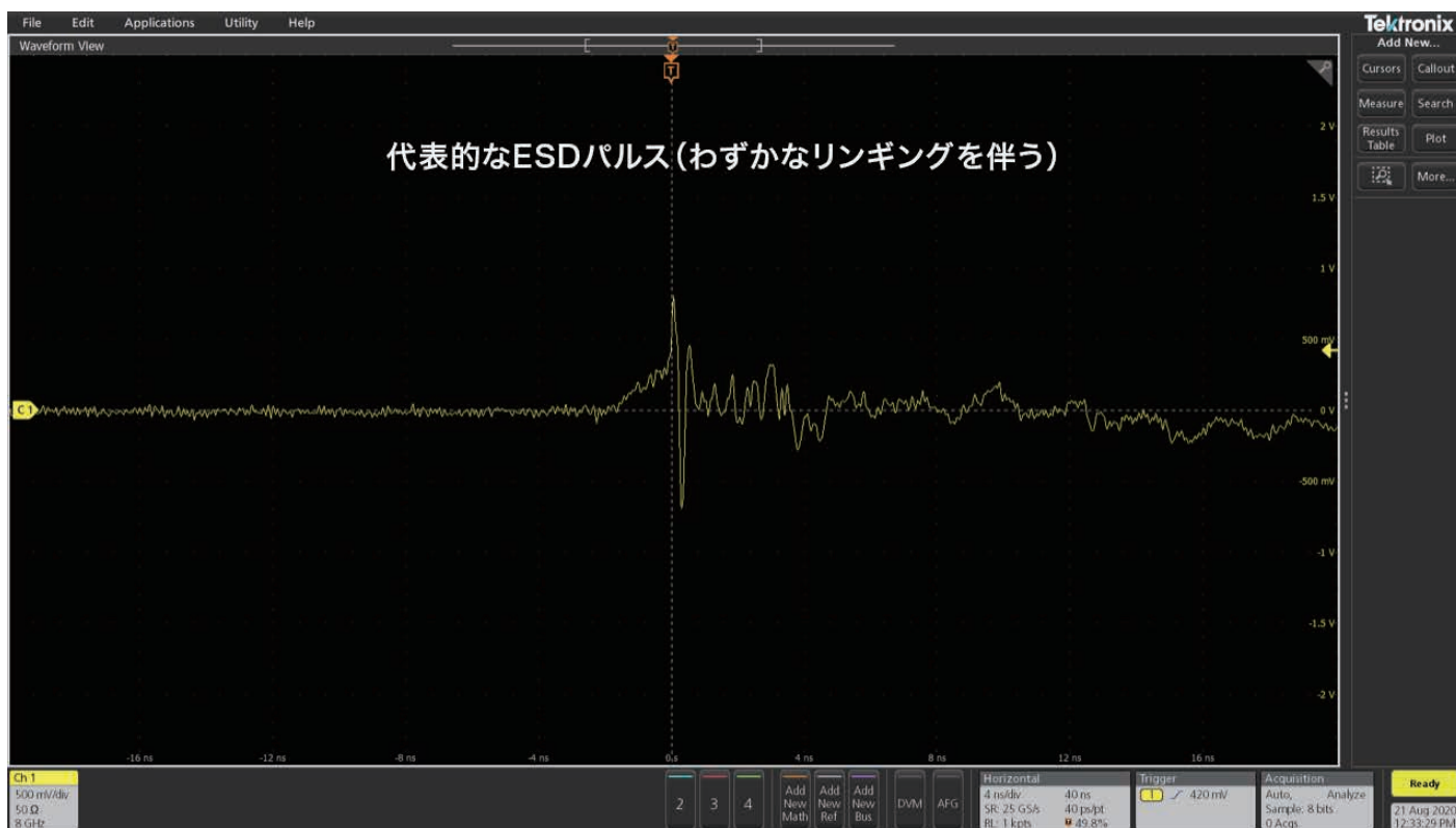
図6. 近接プローブをESD電流の経路に近づけた時の代表的なリングング・パルス
