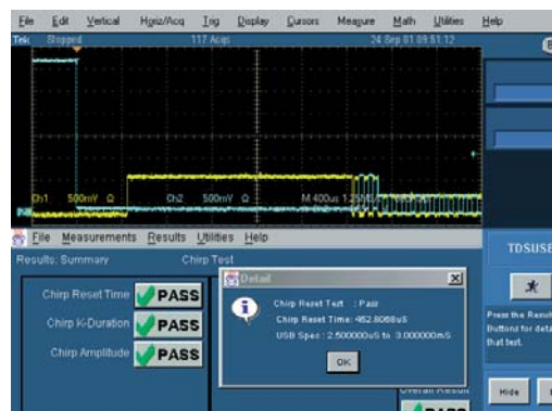
HS CHIRPテスト測定／結果判定
