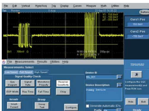
HS Receiver Sensitivityテストの実行例
