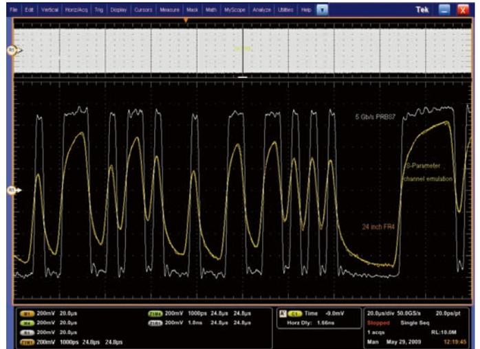
図12. 60cm長のハードウェア・チャンネルとソフトウェアによるエミュレーション
