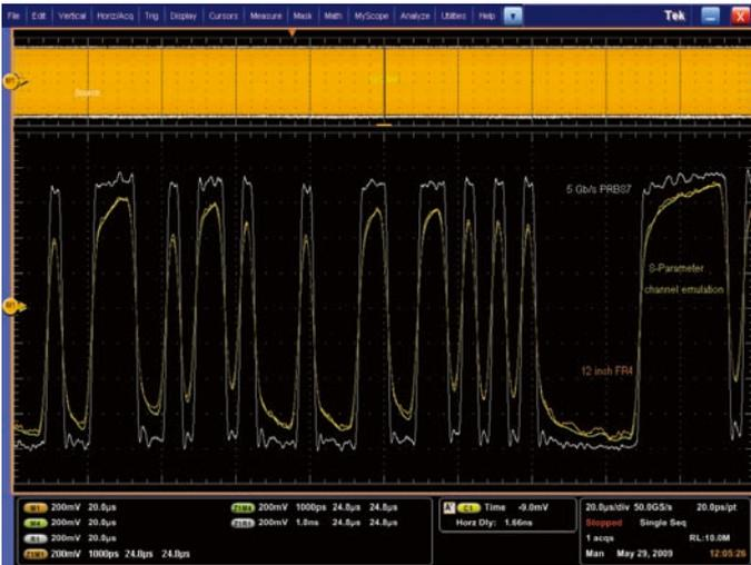
図11. 30cm長のハードウェア・チャンネルとソフトウェアによるエミュレーション
