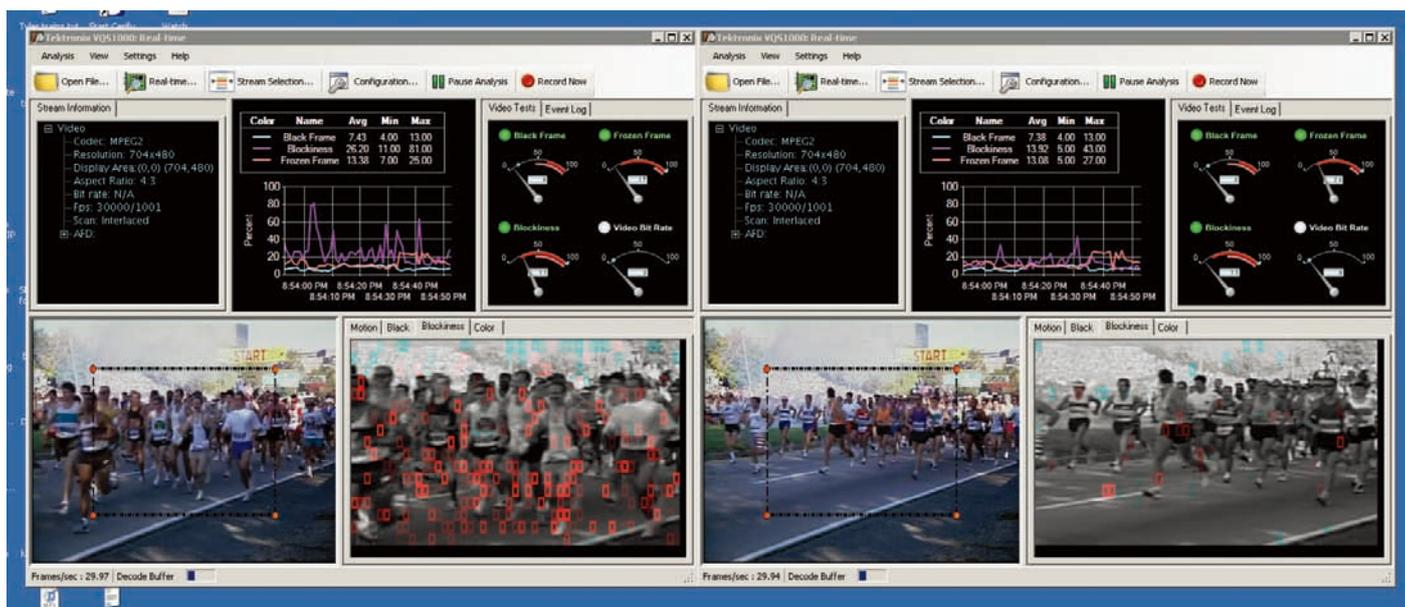
図9. 2つのエンコーダにより、同じビデオ・コンテンツを2Mbpsと8Mbpsで圧縮した例
