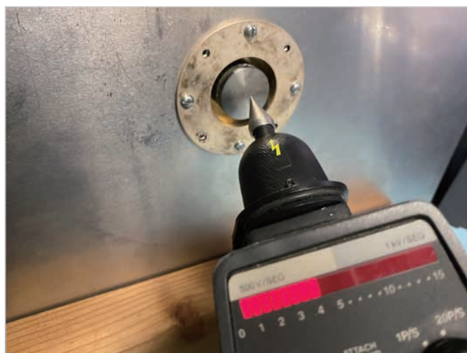
図6. 接触放電チップは、パルスを出力する前にターゲットの中心に当てる。
