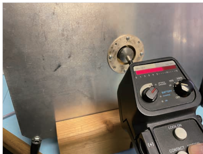
図9. 気中放電試験では、ターゲットの中心に対して90°の角度で向ける。新しいスタイルのターゲットでは、正確に向けることがさらに難しくなっている。
