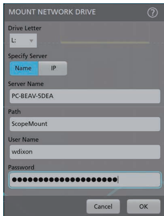
図8.6シリーズMSOにおけるネットワーク・ドライブのマウントの例
