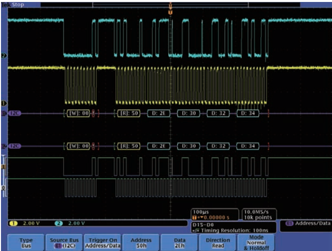
図55. シリアル・パケットの内容での自動トリガ、デコード機能、サーチ機能により、シリアル・バス解析が効率良く行える
