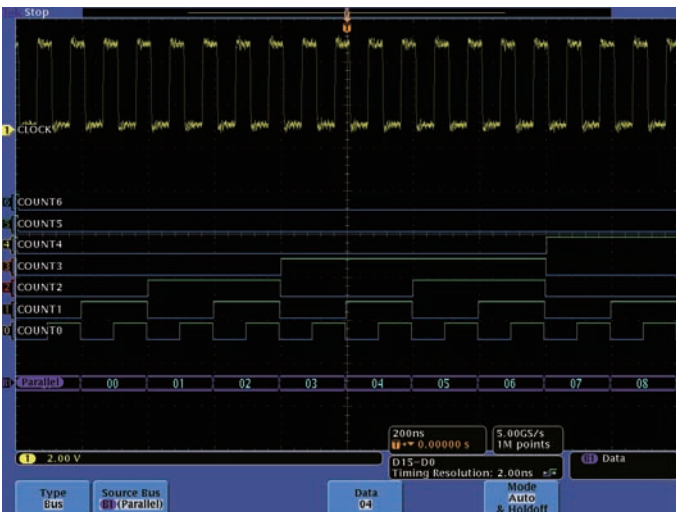
図56. クロック同期/非同期の平行バス・データへの自動トリガ、デコード、サーチ機能
