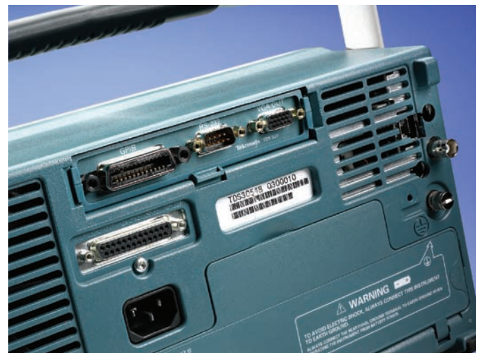
図53. セントロニクス・ポートを標準で装備していたり、オプションでEthernet/RS-232、GPIB/RS-232、VGA/RS-232のインタフェース・モジュールを挿入しているオシロスコープもある。前面パネルにUSBポートを装備しているものもある
