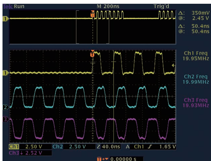
図13. デジタル・ストレージ・オシロスコープで取込んだ、複数のチャンネルにおける高速の単発信号。捕捉の難しいグリッチやトランジェント・イベントを取込むことができる
