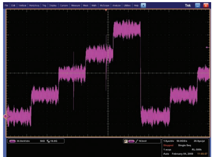
図24. ピーク・ディテクト・モードでは、非常に短時間のトランジェント異常が捕捉できる
