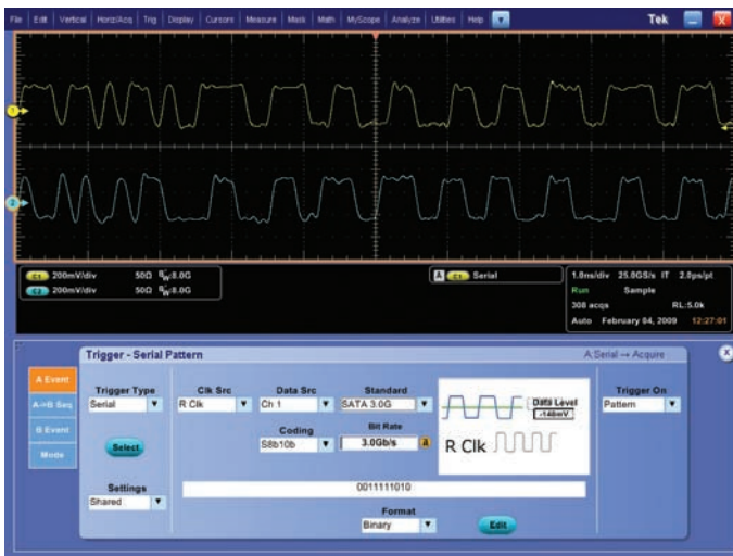
図49. DPOは、繰返し性のない信号、高速信号、マルチチャンネルのデジタル設計アプリケーションに適している
