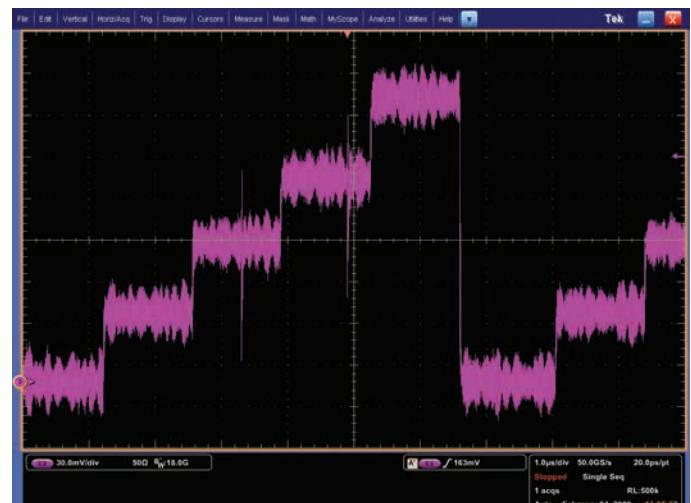
図24. ピーク・ディテクト・モードでは、非常に短時間のトランジエント異常が捕捉できる
