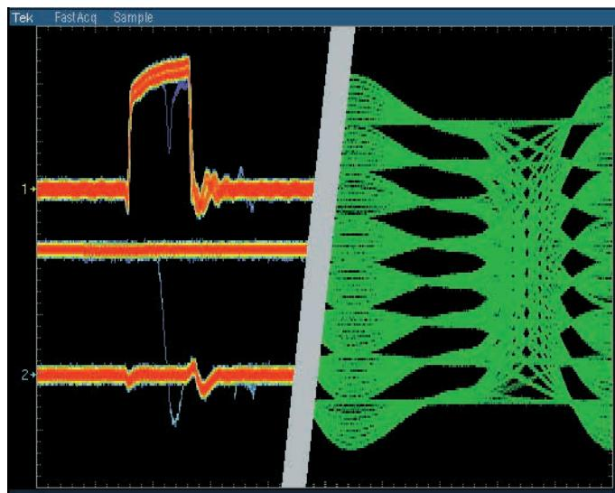
図15. DPOはわずか数秒で数百万の波形を取込む機種もあり、間欠的に捉えにくい現象を取り込み、信号の振る舞いを測定できる可能性が大幅に向上する
