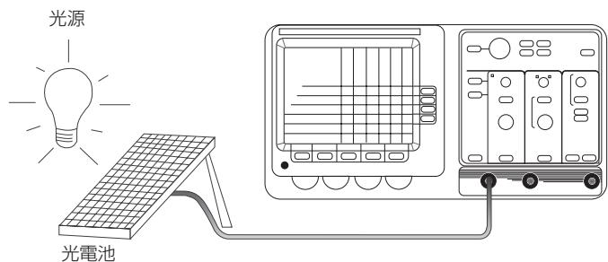
図1. オシロスコープを使用した科学データ収集の例
