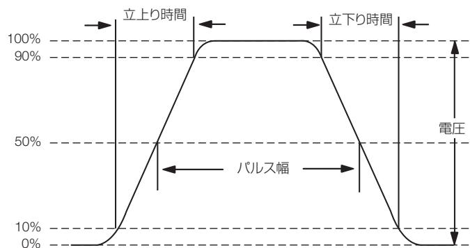
図69. 立上り時間とパルス幅の測定ポイント
