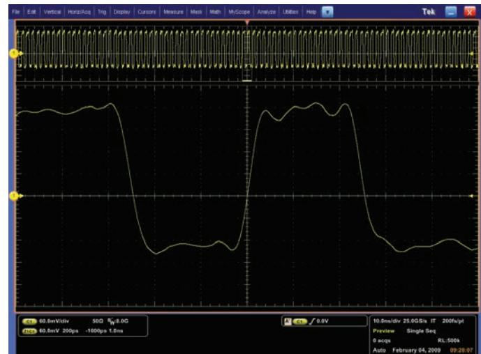
図46. 高速デジタル信号の立上り時間特性
