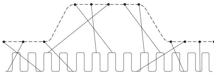
図31. ランダム等価時間サンプリングでは、サンプリング・クロックは入力信号、トリガとは非同期に動作する
