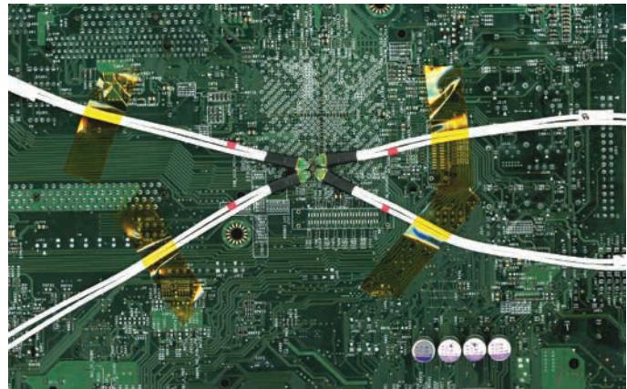
図39. 実装密度の高いデバイス、システムでは小型のプローブが必要
