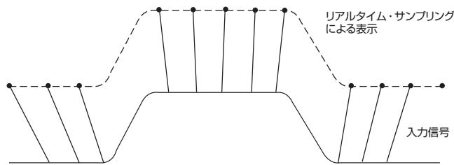
図27. この10nsのパルスをリアルタイムで捕捉するには、エッジ部を正確に表現するために高いサンプル・レートが必要
