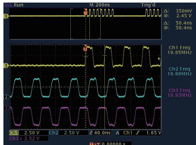
図13. デジタル・ストレージ・オシロスコープで取込んだ、複数のチャンネルにおける高速の单発信号。捕捉の難しいグリッチやトランジエント・イベントを取込むことができる
