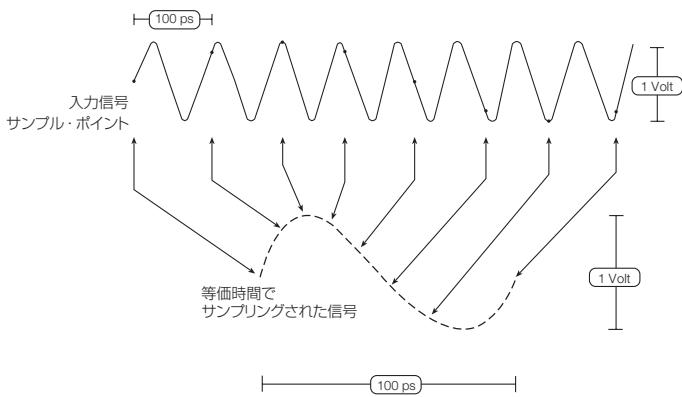
図25. 等価時間補間サンプリング：サンプル・ポイント間を補間にによって補い、連続波形を作成する
