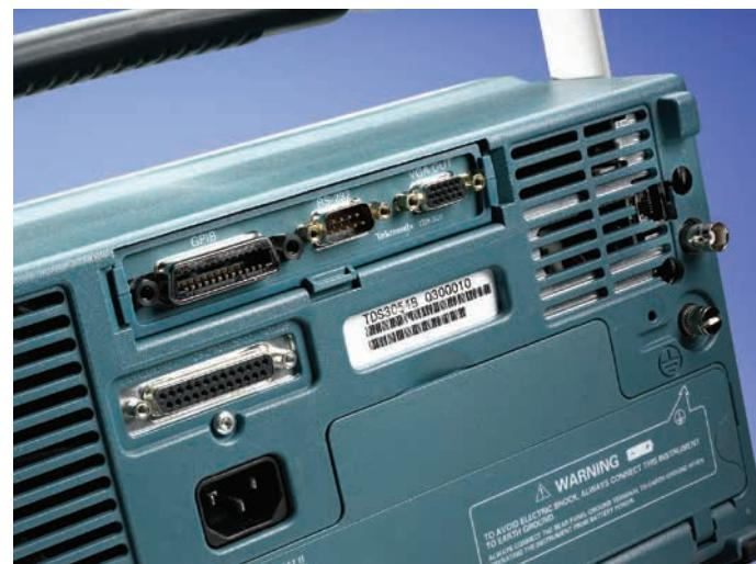
図53. セントロニクス・ポートを標準で装備していたり、オプションでEthernet/RS-232、GPIB/RS-232、VGA/RS-232のインターフェース・モジュールを揃えているオシロスコープもある。前面パネルにUSBポートを装備しているものもある
