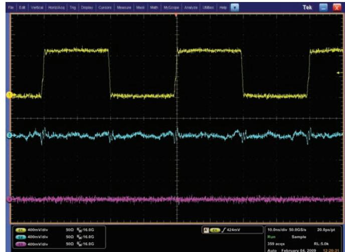
図42. 差動プローブは、今日の高速、低電圧用途で使用される信号からコモン・モード・ノイズを分離できる。特にデジタル信号がノイズ限界近くまで下がってきた近年では特に重要になってきている
