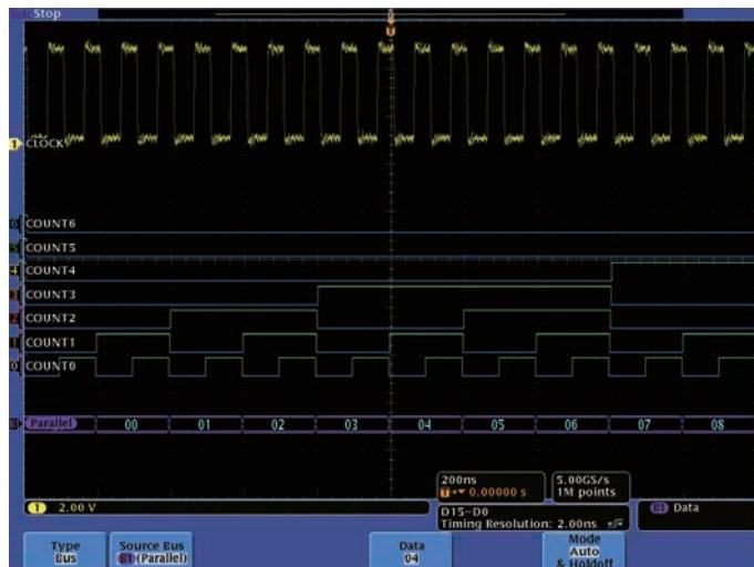
図56. クロック同期／非同期のパラレル・バス・データへの自動トリガ、デコード、サーチ機能
