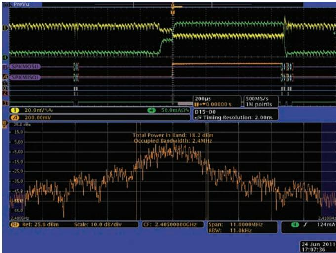
図16. Zigbee無線のマイクロプロセッサSPIの（MOSI）と（MISO）のコントローラ・ラインの時間相関表示と、ターンオン時の無線ICへのドレイン電流／電圧のスペクトラム測定例
