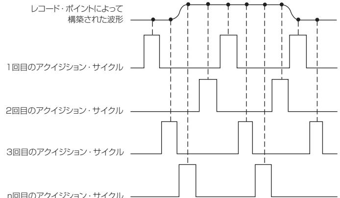
図30. 高速の繰返し信号を捉えるのに、等価時間サンプリングを採用しているオシロスコープもある
