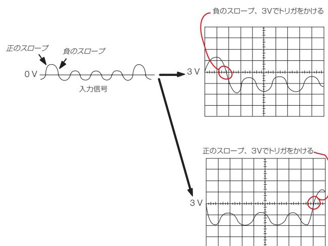
図35. 正のスロープ、負のスロープによるトリガ
