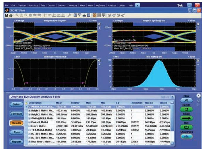
図54. 解析ソフトウェアは、最新のハイスピード・デジタル設計で必要となるジッタ／アイ・ダイアグラム測定に最適
