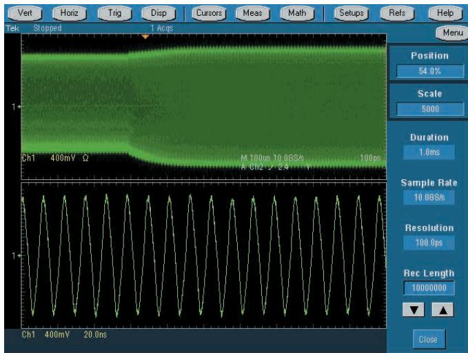
図51. 85MHzの変調搬送波の高周波成分を取り込むには、高分解能サンプリング(100ps)が必要。変調エンベロープの観測には長い時間間隔(1ms)が必要。ロング・メモリ(10MB)があれば、その両方を表示することができる
