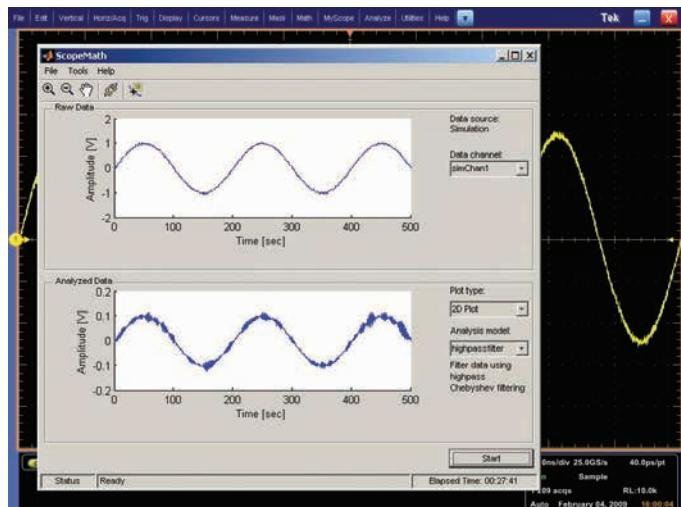
図59. WindowsベースのオシロスコープにはMATLAB<sup>®</sup>などの解析ソフトウェアがインストールできるため、ローカルでの信号解析が可能
