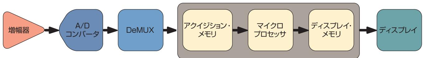
図12. デジタル・ストレージ・オシロスコープ (DSO) のシリアル処理アーキテクチャ
