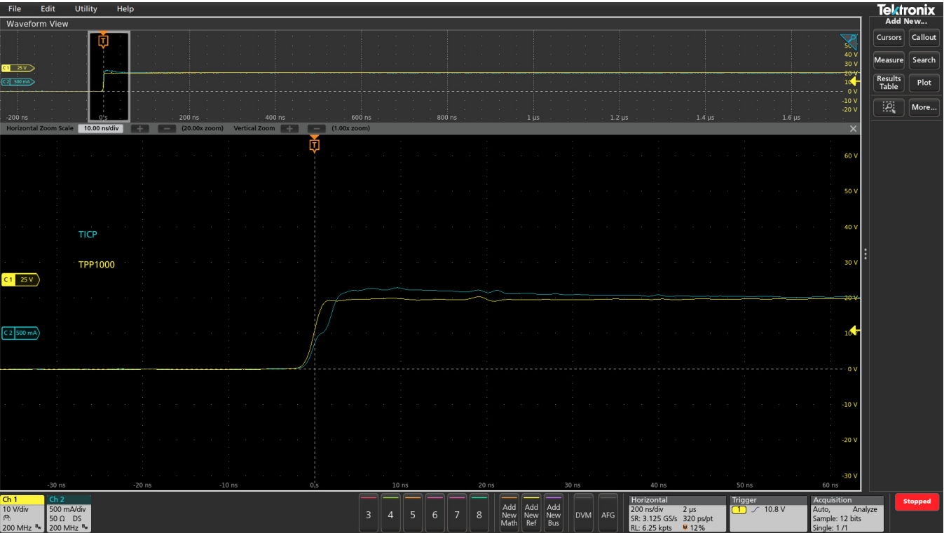
图 12. 快速阶跃发生器边沿的测量,类似于图 5,但在分流器两端应用了低通 RC 滤波器。黄色迹线是使用连接到发生器输出的 1\text{GHz} 无源探头测量的。蓝色迹线来自测量安装了低通滤波器 ( R=50\ \Omega , C=547\text{ pF} ) 的 50\text{ m}\Omega 分流器两端电压的电流分流探头。
