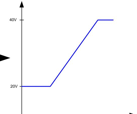
So würde die resultierende Rampe der Ausgangsspannung aussehen, sofern das Gerät nicht in CC oder CP wechselt.
