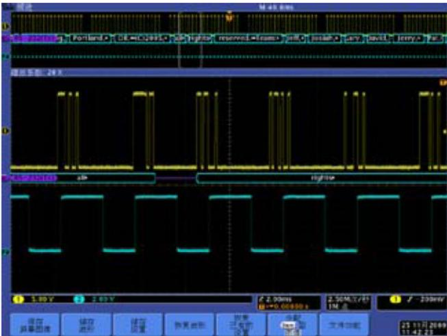
圖 4. 黃色的 RS232 波形自動解碼，同時測試到一組時脈訊號
