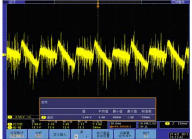
圖 4. 儲能電容的漣波量測
