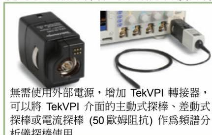
無需使用外部電源，增加 TekVPI 轉接器，可以將 TekVPI 介面的主動式探棒、差動式探棒或電流探棒 (50 歐姆阻抗) 作為頻譜分析儀探棒使用
