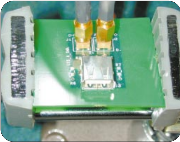
▶ 図11: USB2.0コンプライアンス・テストにおけるTDR測定治具
