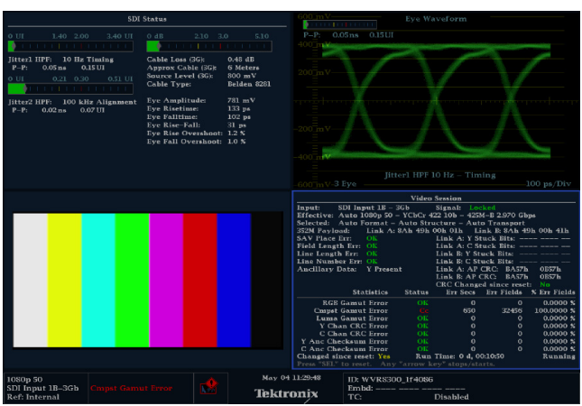
图. WFM8300 关于 SDI 信号的规范性及眼图测试
