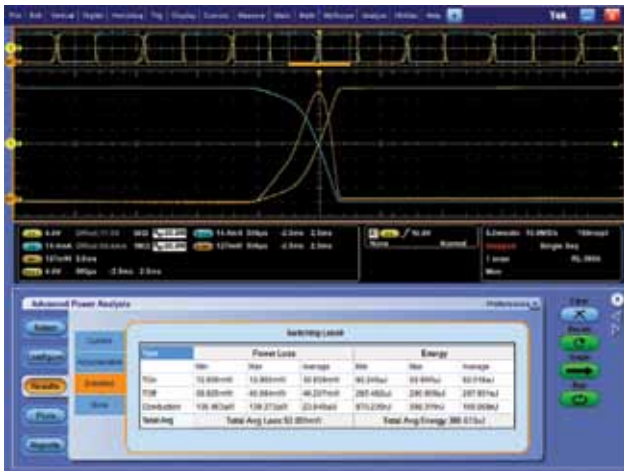
图 5. DPOWPR 自动开关损耗测量。
