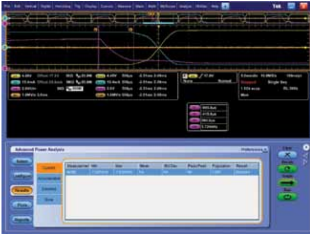
图 7. 自动测量 MOSFET 栅极转换速率。
