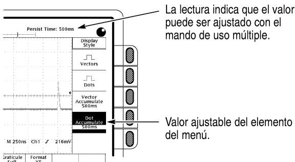
3. Seleccione un elemento del menú auxiliar, si aparece en la pantalla.
