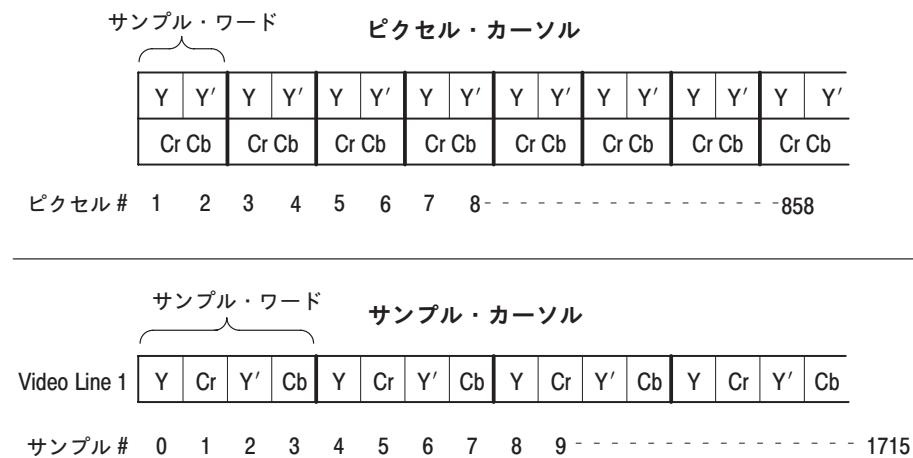
図 3-29：ピクセル・カーソルとサンプル・カーソルのサンプリング原理
