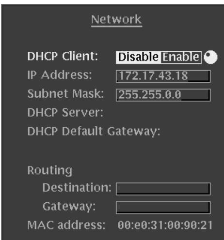
**DHCP Client :** DHCP (Dynamic Host Configuration Protocol) による IP アドレスの設定のオン／オフを設定します。Enable に設定すると、本機器は、DHCP サーバから自動的に IP アドレスを取得します。Disable に設定した場合は、次の各項目でアドレスを入力する必要があります。なお、DHCP サーバ機能については、使用しているサーバ OS に付属のマニュアルを参照してください。
