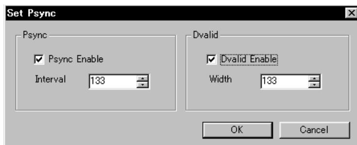
**Psync** フィールド : ECL/TTL/LVDS コネクタから出力される PSYNC 信号のステータスを設定することができます。Interval では、PSYNC 信号の出力間隔を 16 ~ 256 バイトの範囲で指定することができます。なお、Interval 値は、Dvalid フィールドの Width 値と同じかそれ以上の値に設定する必要があります。
