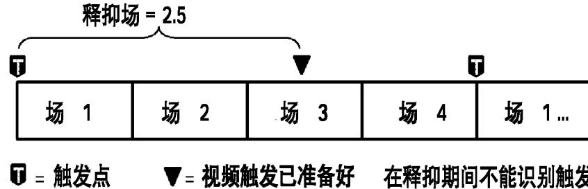
虽然释抑场触发方式可在相同场上触发，但并不允许您准确指定在哪个场上触发。使用“单个序列”(SINGLE SEQ) 按钮可在某个特定场上重新触发示波器。
