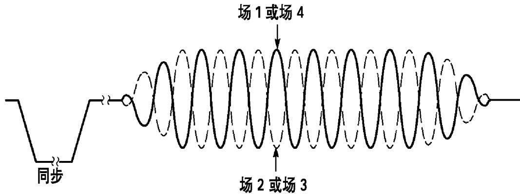
13. 如果示波器在场 2 上触发，可反复按下“SINGLE SEQ”（单个序列）按钮，直到场 1 的彩色脉冲波形改变为正确相位，然后按下“RUN/STOP”（运行 / 停止）按钮来恢复触发示波器。
