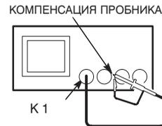
4. Нажмите кнопку AUTOSET (Автоустановка). На экране должен быть отображен сигнал в форме меандра (примерно 5 В с частотой 1 кГц).
