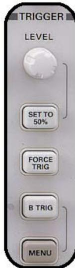
**Figure 4.1: TDS3000 TRIGGER controls**
