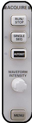
*Figure 1.10: TDS3000 ACQUIRE section controls*
