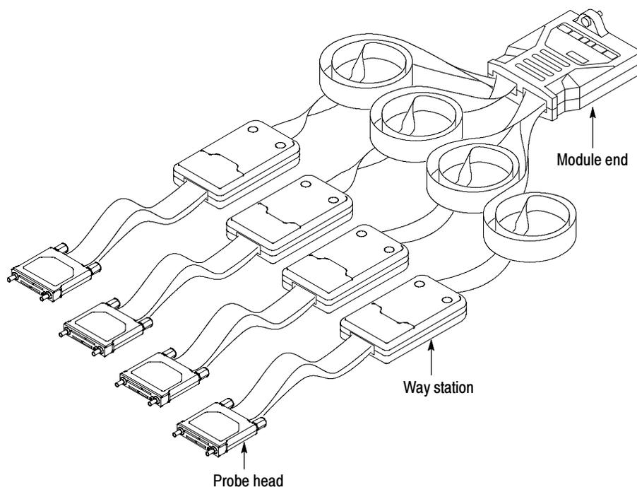
**Figure ii: Probe example**
