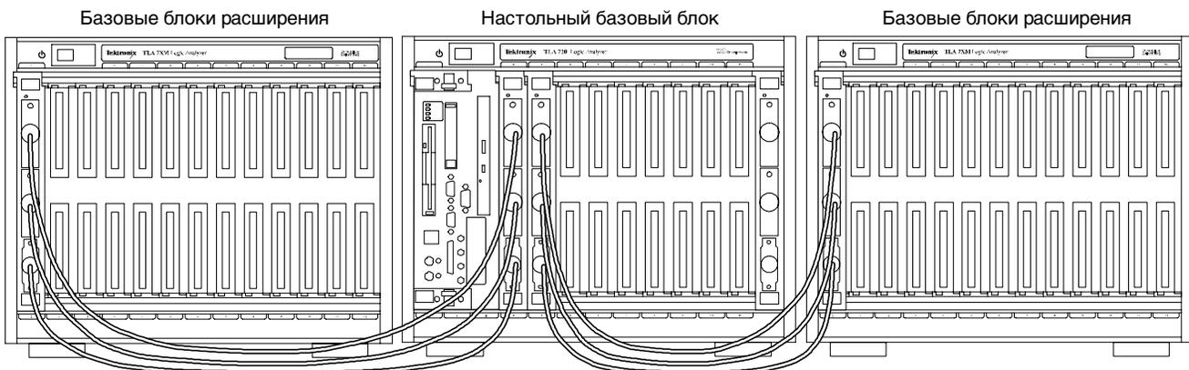
**Рис. 1-5: Настольный базовый блок с двумя базовыми блоками расширения**
