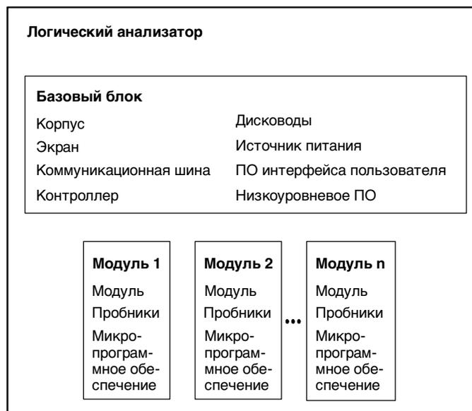
Рис. 2-30: Физическая модель логического анализатора
