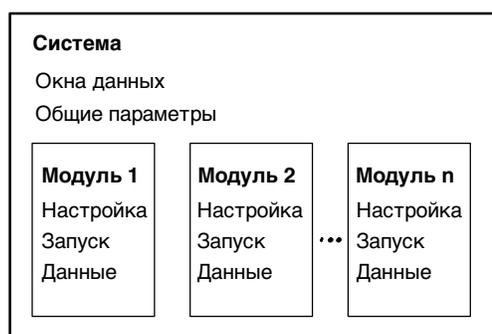
**Рис. 3-52: Концептуальная модель логического анализатора**
