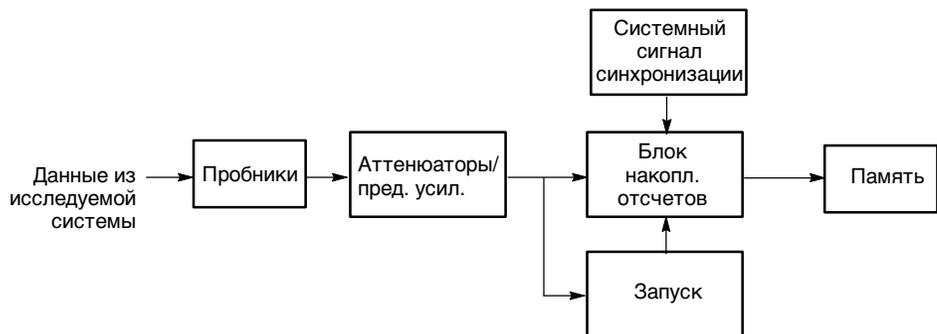
**Рис. 2-28: Блок-схема системы накопления отсчетов и хранения модуля ЦЗО**
