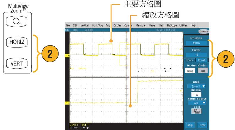
3. 若要調整縮放方格圖的大小，從 **Vertical**（垂直）或是 **Horiz/Acq**（水平／擷取）功能表中選取 **Zoom Graticule Size**（縮放方格圖尺寸）。
