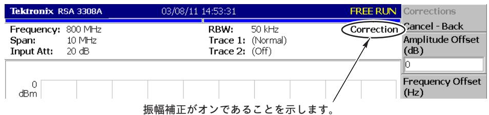
図 4-14：振幅補正のセットアップ表示
