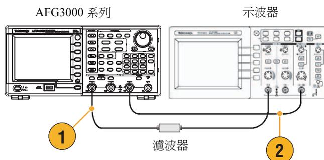
3. 在任意 / 函數產生器的「執行模式」中選擇「掃描」，設定開始頻率、停止頻率和掃描時間，讓波形顯示在方格圖中。
