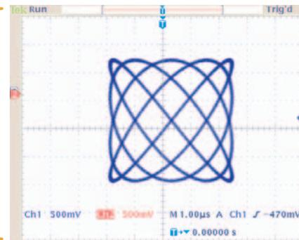
3. 使用任意 / 函數產生器上的通用旋鈕，變更 CH1 或 CH2 的相位。觀察 Lissajous 邏輯組合的變更形狀。
