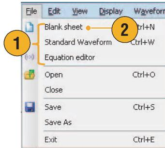
3. 使用「Standard Waveform」對話方塊，建立可用的任何一種標準波形。使用「Settings」，選擇需要的波形和儀器類型。
