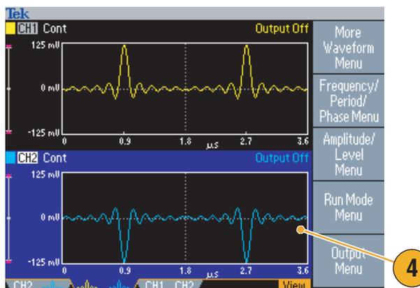
*注意：在 AFG310x 或 AFG325x 系列儀器中選取 CH1 時，該儀器會在「輸出」功能表中顯示「外部增加關閉/開啓」。*
