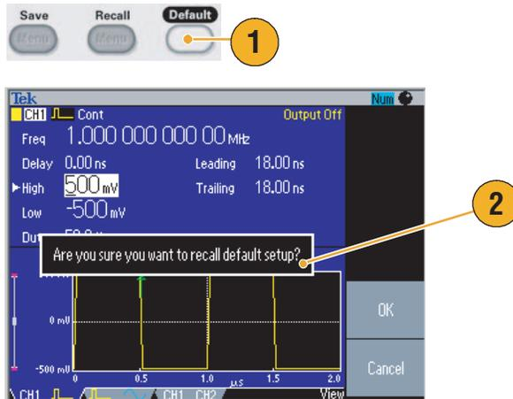
3. 如果您選取「確定」，儀器會顯示如預設的設定 1 MHz 頻率，1 V<sub>p-p</sub> 振幅的正弦波形。
