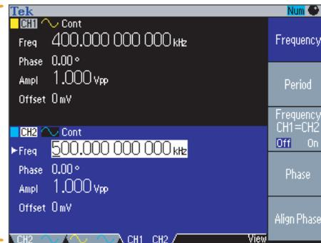
2. 將示波器的顯示格式設為 XY。調整振幅，讓波形顯示在方格圖中。會顯示 Lissajous 邏輯組合。
