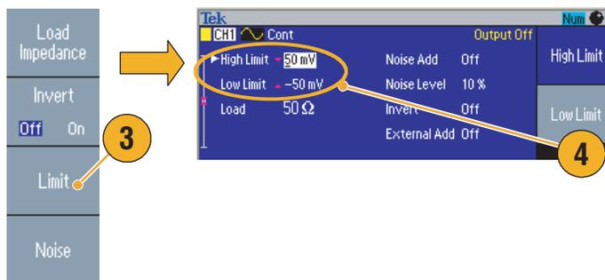
5. 請按前面板「正弦波」按鈕來顯示波形參數。確認高、低電壓位準已改變。
