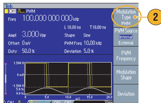
3. 將輸出連接至示波器。確認示波器螢幕上有顯示脈波寬度調變波形。
