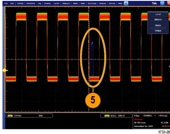
6. Um auf dem in Schritt 5 gefundenen Glitch zu triggern, wählen Sie **Glitch Setup...** (Glitch-Einstellung...) aus.
